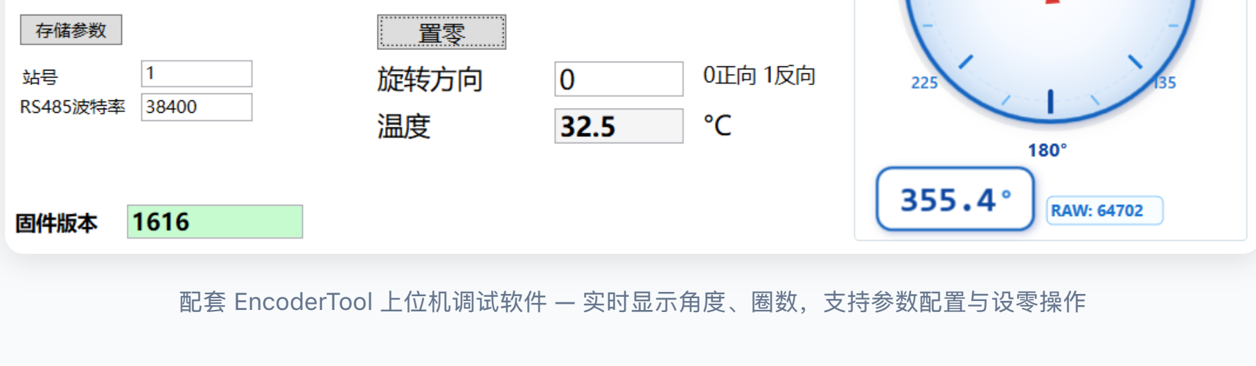
配套 EncoderTool 上位机调试软件 — 实时显示角度、圈数，支持参数配置与设零操作
